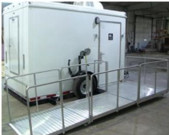
圖4-1-4、符合美國身心障礙法案無障礙指引（ADAAG）之拖車式無障礙流動廁所
