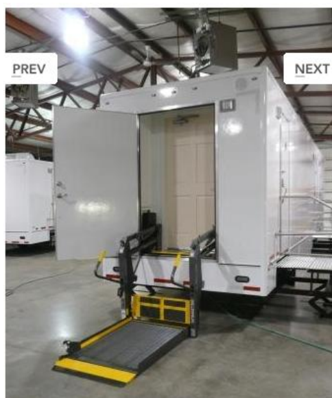
圖4-1-5、符合美國身心障礙法案無障礙指引（ADAAG）之拖車式 無障礙流動廁所(升降機式)
