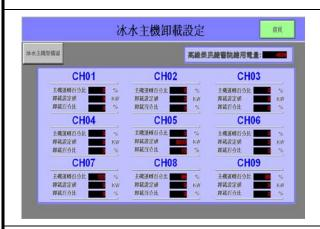
BEMS 之空調主機加卸載功能,有效管理空調 主機群臺數運轉,防止尖峰用電超約罰款。
