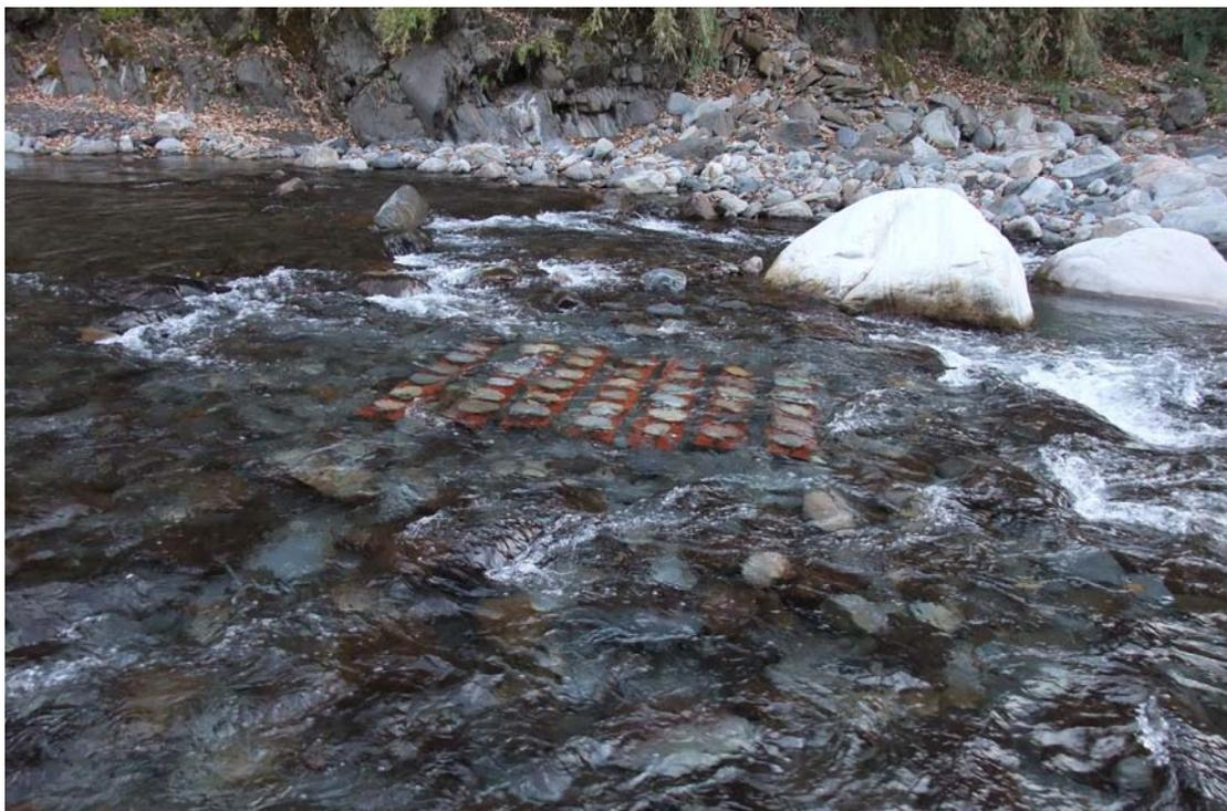
圖 1-3 流速、水棲昆蟲種類與數量對石附生藻生物量影響之實驗設計圖
