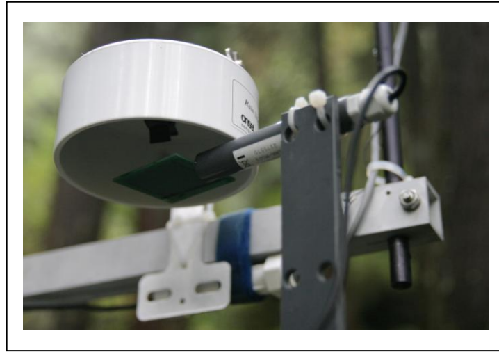
圖 2-10 (上)HOBO S-LWA-M003 葉片濕潤度感測器(下)增加遮罩與感測面朝下的葉片濕潤度感測器。
