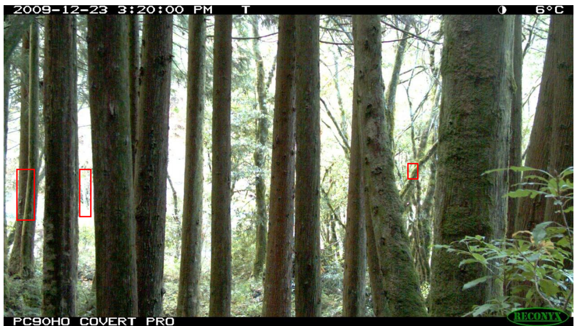
圖 2-5 巨木林道 2.5K 西方山谷 DIA 分析位置和其與 TLI 相機的相對距離。左區 26 公尺(大霧)，中區 67 公尺(輕霧)，右區 24 公尺(大霧)。
