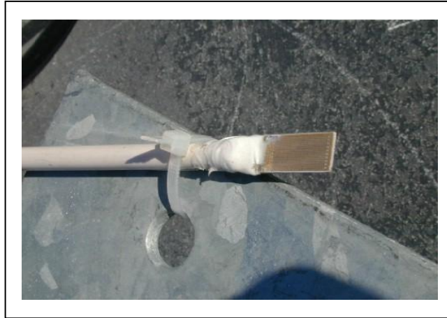
圖 2-6 美國航空太空總署(NASA) AERONET (Aerosol robotic network) 用來偵測下雨事件的 wet sensor。
