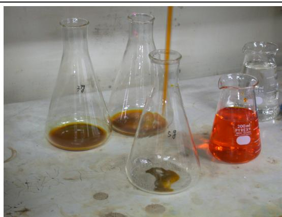
定量  $\text{Cr}_2\text{O}_7$  進行土壤有機質測定
