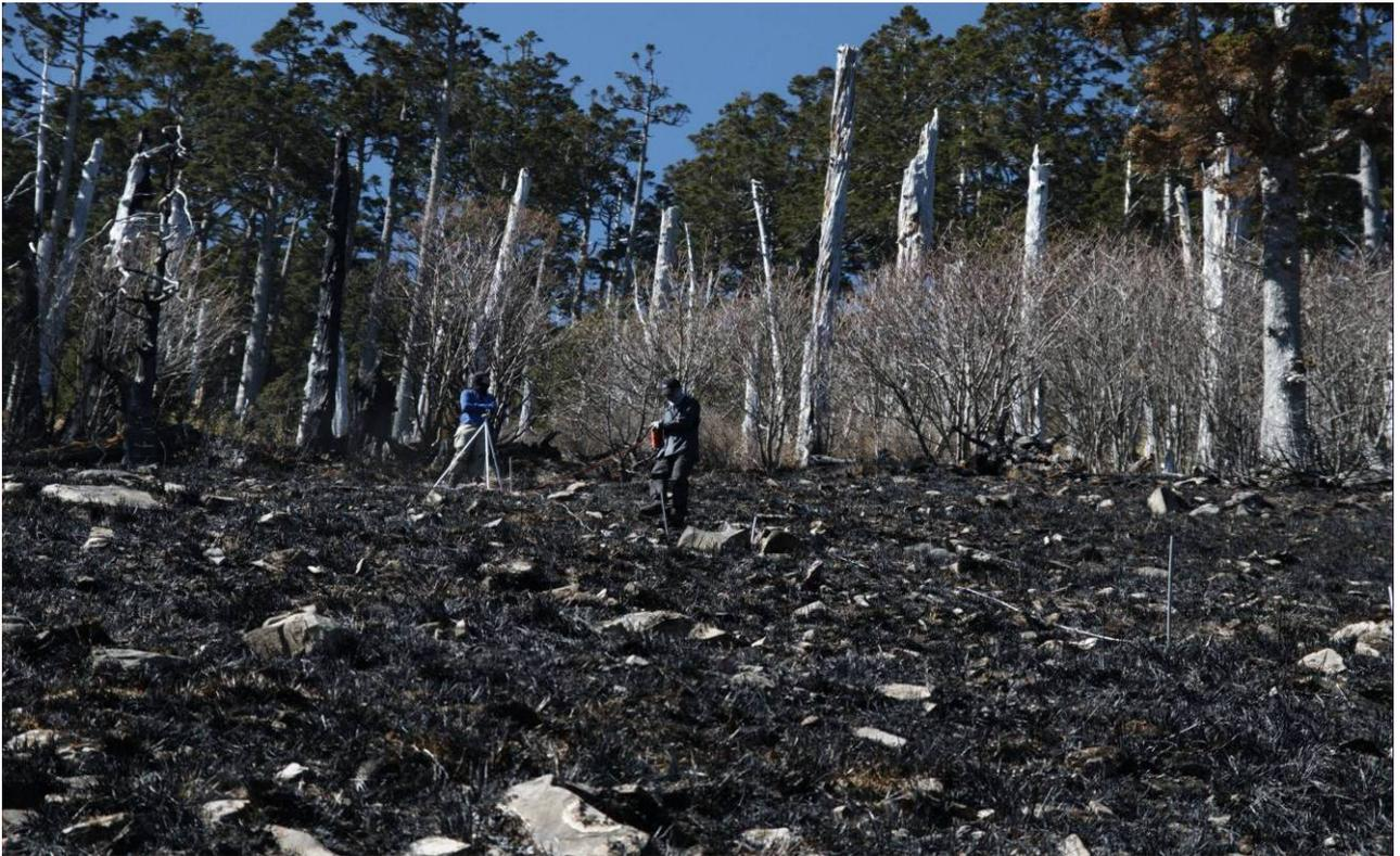
照片 8-1 樣區之最上界設立：以羅盤儀定出一水平線為基準，沿水平線拉皮尺及紅繩，相隔 25m 往下坡拉設樣區(垂直最上界的紅繩)。
