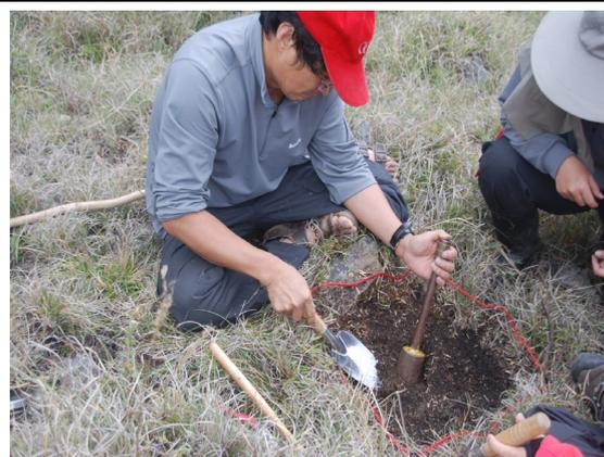
以採土圓桶採集土樣測定土壤容積密度
