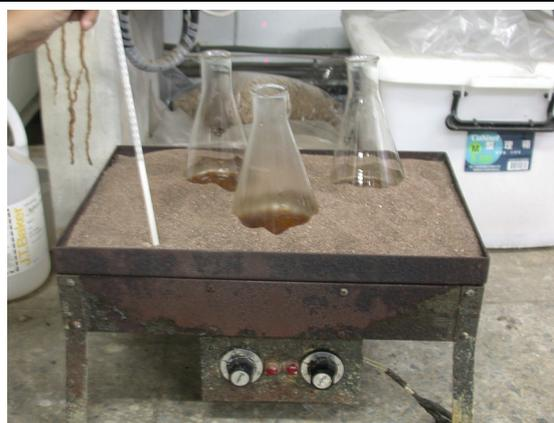
砂盤加溫至  $150^\circ\text{C}$  氧化土壤中有機碳
