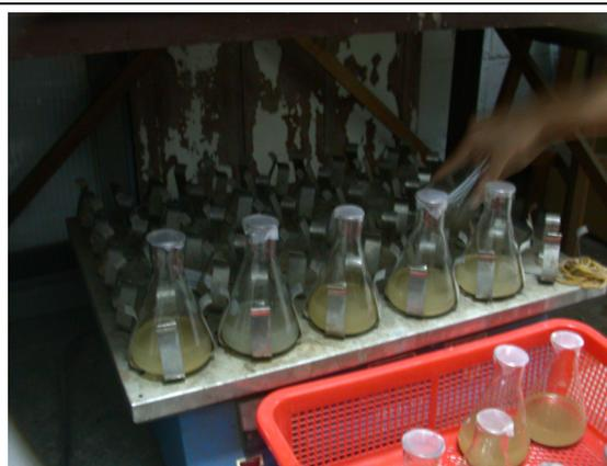
以 1 N  $\text{NH}_4\text{AOC}$  置換土壤陽離子
