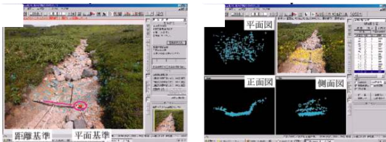
圖 10 三角網的製作與調整
