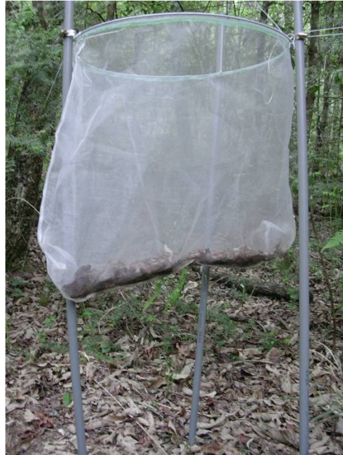
圖 6-4. 枯落物收集網之架設示意圖
