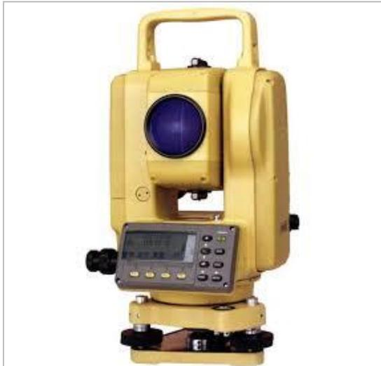
圖 2-1 全測站電子光波測距經緯儀
