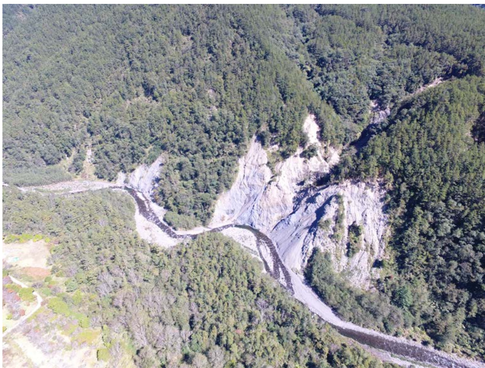
圖 5-29 二號壩上游 415 m 處邊坡側向侵蝕現地照片
