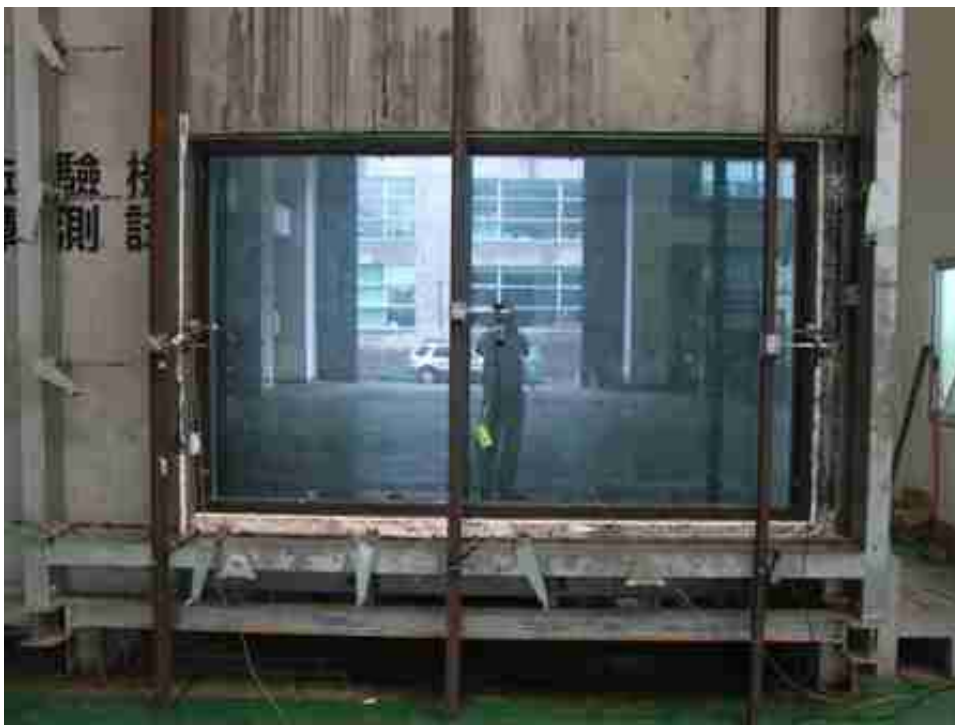
圖1 門窗抗風壓爆破性試驗前真空玻璃窗試體
