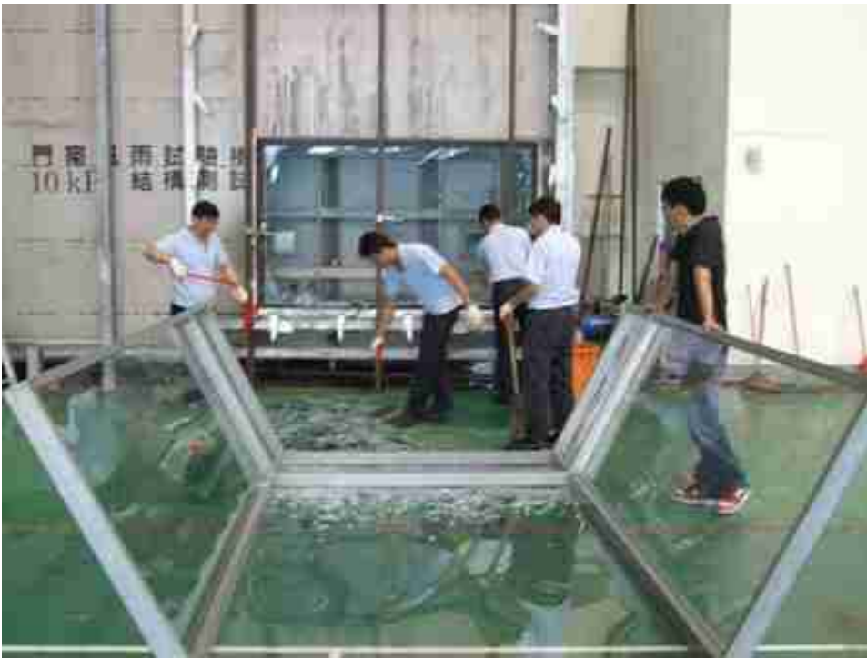
圖2 門窗抗風壓爆破性試驗後真空玻璃窗破裂情形
