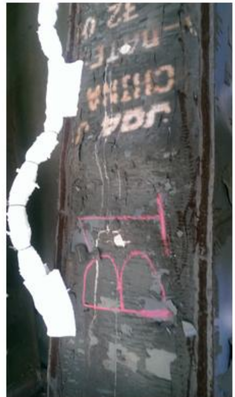
圖1 試體TA1軸向變形與升溫時間之關係及局部挫屈情形 (資料來源：本研究整理)
