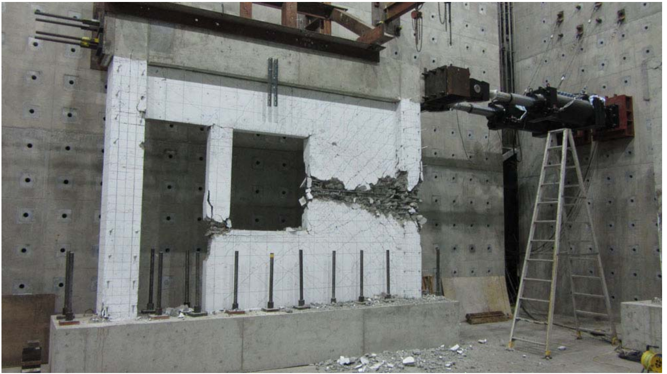
圖2 本所委託研究「低矮鋼筋混凝土沿街店鋪住宅典型開口外牆耐震性能提昇之實驗研究」
