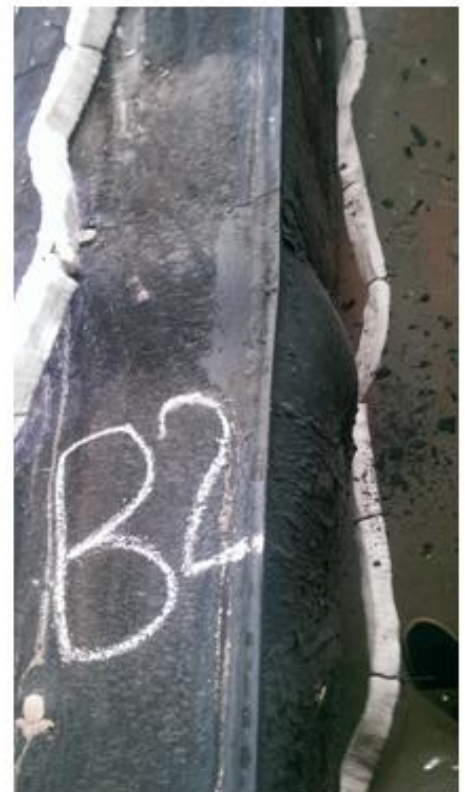
圖2 試體TB1軸向變形與升溫時間之關係及局部挫屈情形 (資料來源：本研究整理)
