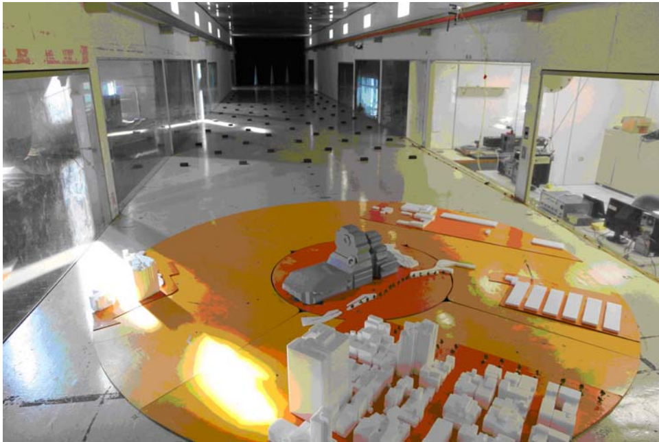
圖2 高雄海洋文化及流行音樂中心風洞實驗設定
