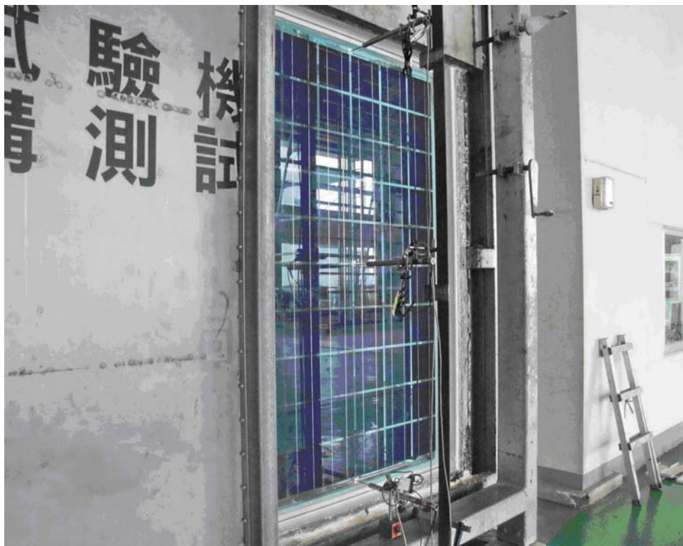
進行10,000 Pa之BIPV抗風壓試驗
