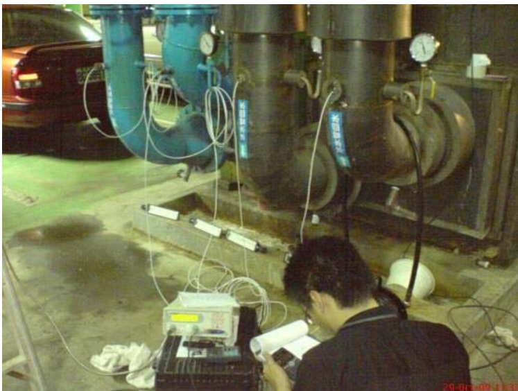
圖2 空調主機進行TAB之測試
