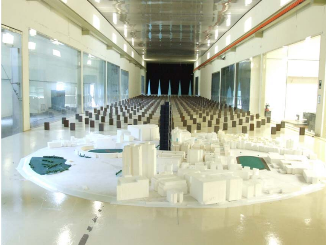
圖一、建築模型於風洞中進行實驗量測
