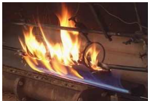
圖4 IEC 60331 燃燒器由側下方加熱
