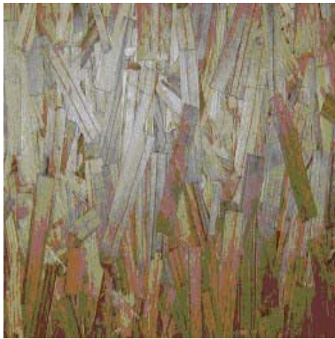
3.利用機械式定向裝置進行定向處理 6.板胚表面覆蓋一經鐵氟龍處理，再送至熱壓機製板
