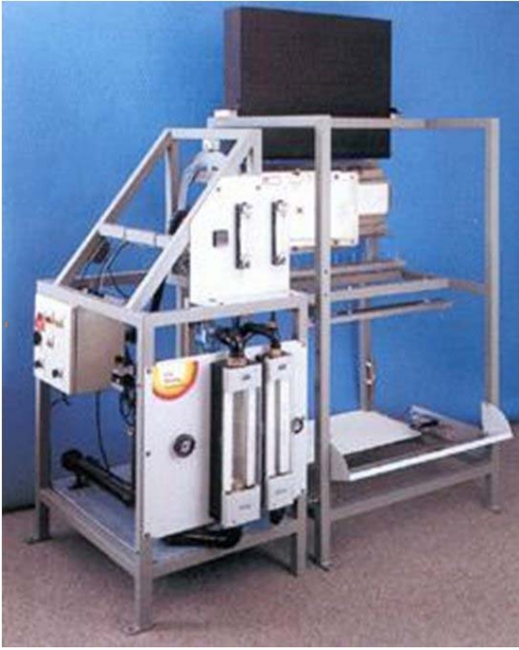
圖一、IFT壁材側向延燒試驗裝置
