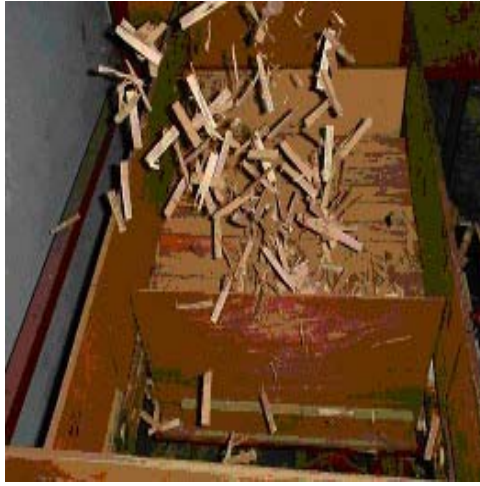
1.利用盤式切削機進行橫向切削薄片 4.機械式定向過程 (配向)
