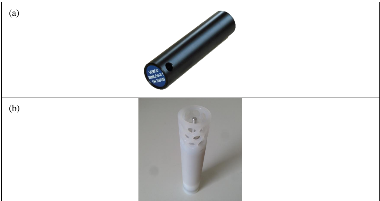
圖 2.9 自計式溫度計：(a) Minilog-II 自記式溫度計 (b) Starmon mini 自記式溫度計
