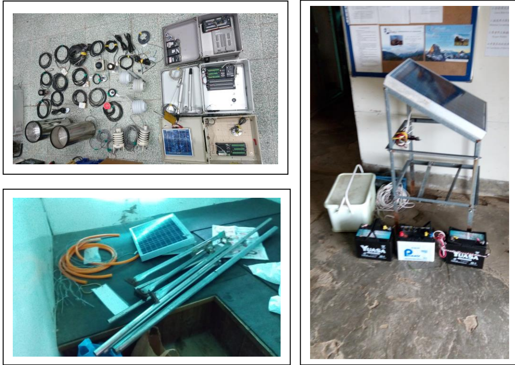
圖 16 SP1 與 SP3 氣象站拆卸後的設備、支架、電瓶、太陽能充電板等，左上角照片是攜回臺灣大學加以報廢，其餘照片內容物均轉移給三六九山莊志工繼續使用。
