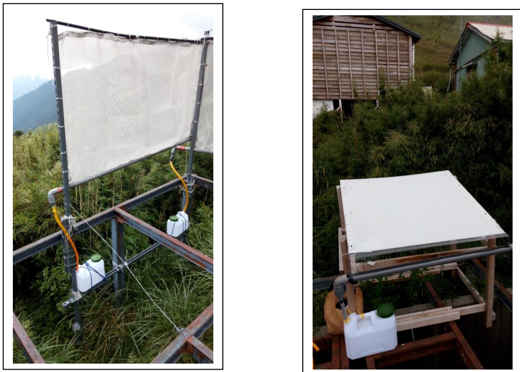
圖 17 SP3 雲霧攔截網(左)與露水攔截平板(右)現地設施和新儲水桶。
