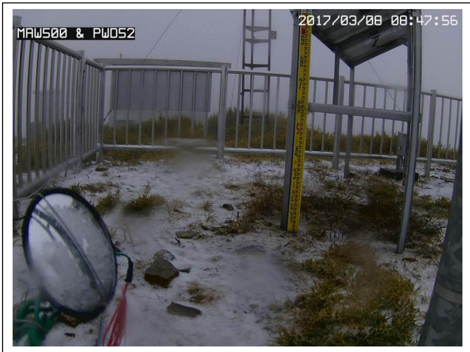
圖 22 翰昇公司於合歡山山頂氣象局測站測試之攝影機拍攝雪尺樣本(2017 年 3 月 8 日)。
