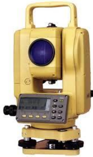
圖 2-1 全測站電子光波測距經緯儀 (資料來源：本研究團隊)
