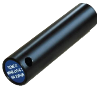
圖 2.16 Minilog-II 自記式溫度計
