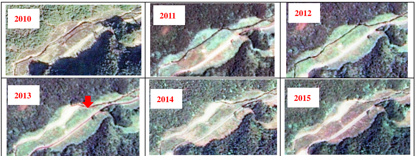
圖 3.12 福衛二號 2010-2015 年有勝溪斷流處之影像 (箭頭所指之處懷疑為 2013 年新生之崩塌地)
