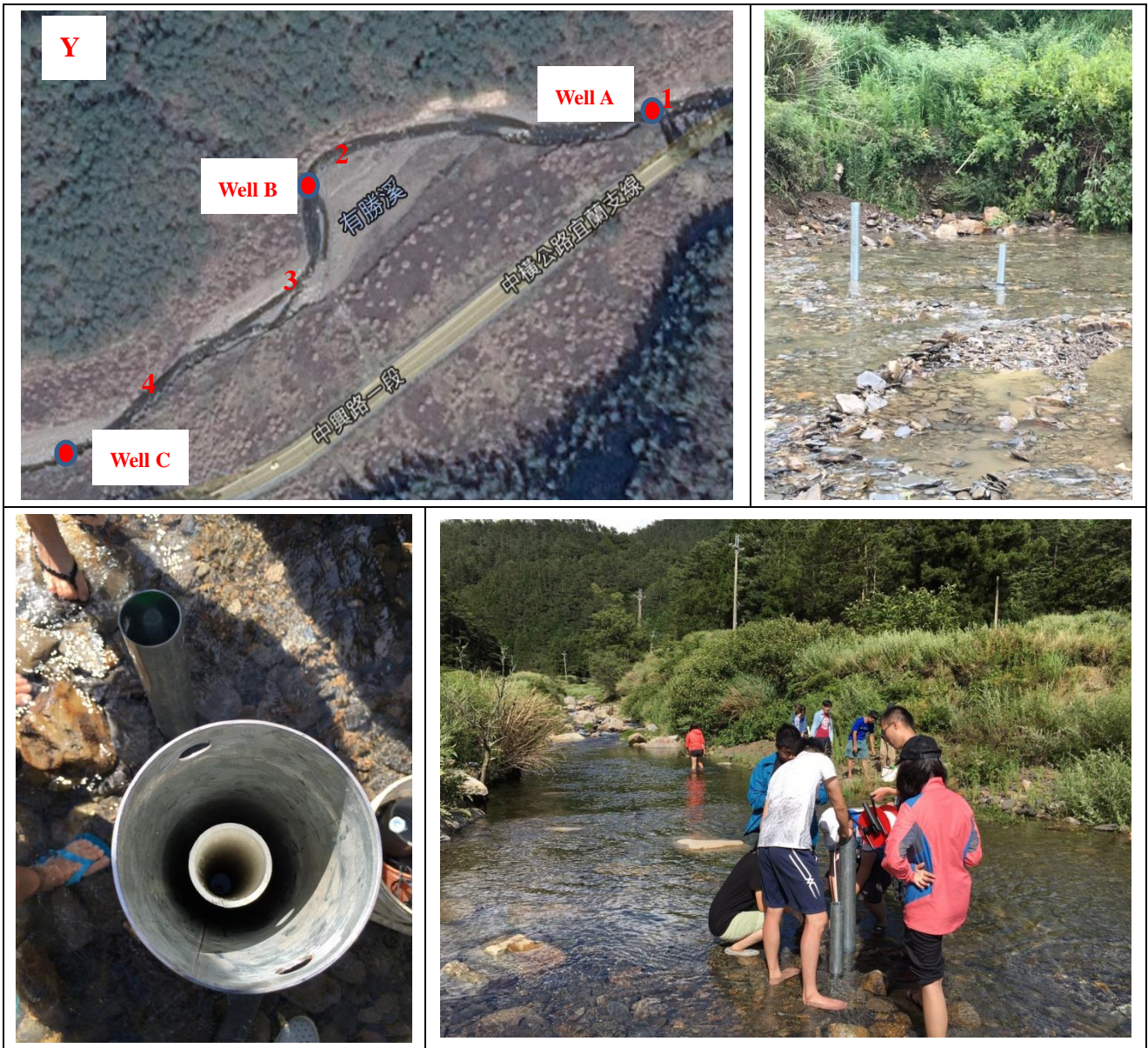
圖 2.12 有勝溪河床上水位及溫度監測井之位置（紅點，共三處）及相關照片（已遭 2016/9/15 侵台之梅姬颱風沖毀）
