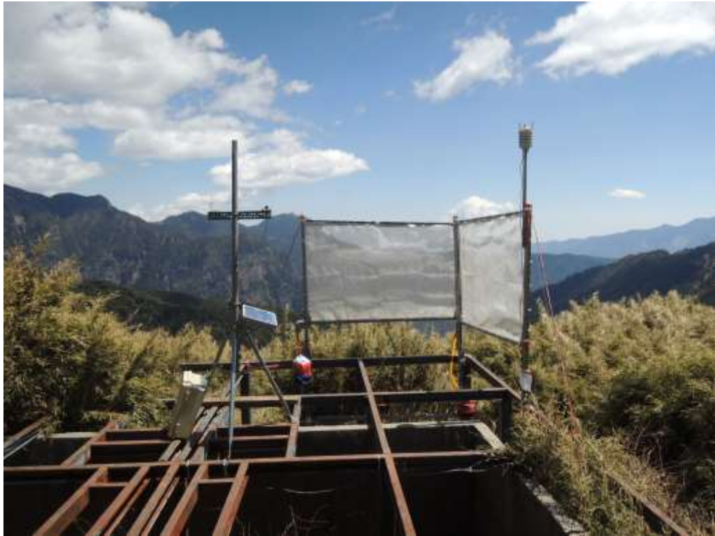
圖 14: 2016 年 4 月架設完成的 369 山莊 WXT520 氣象站與攔截網(近照)。
