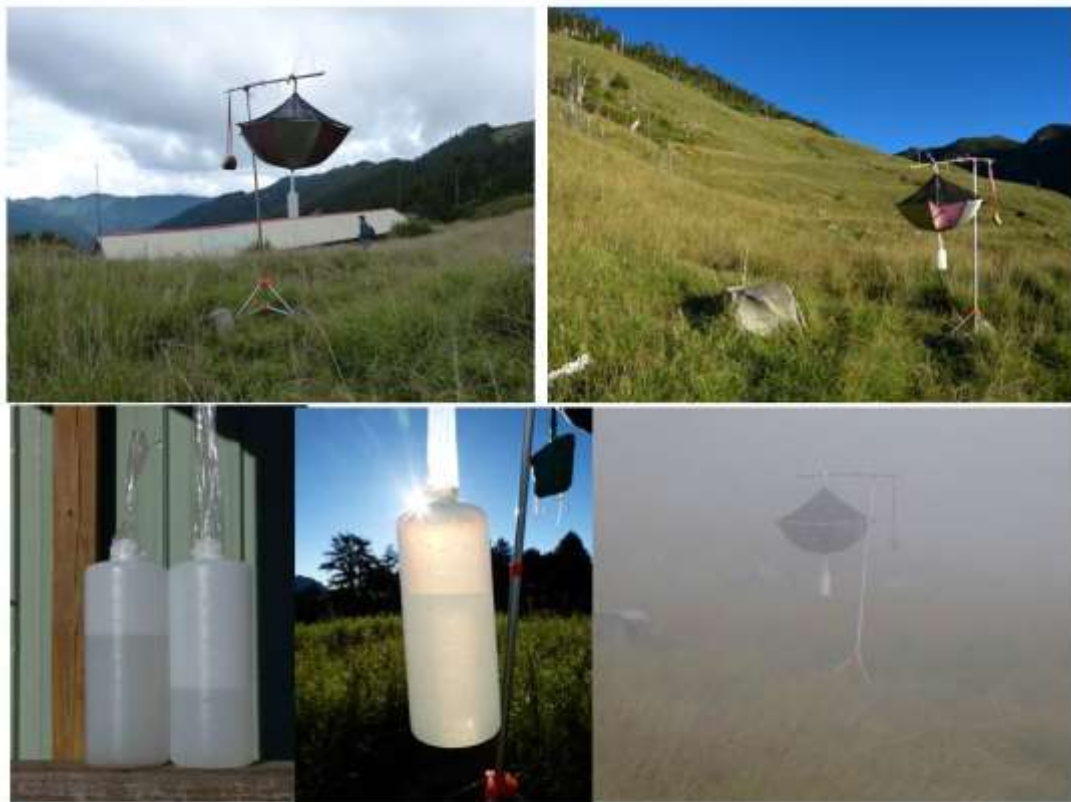
圖 19: 369 山莊後方斜坡雨傘攔截雲霧水測試(2016 年 6 月 20~21 日)。
