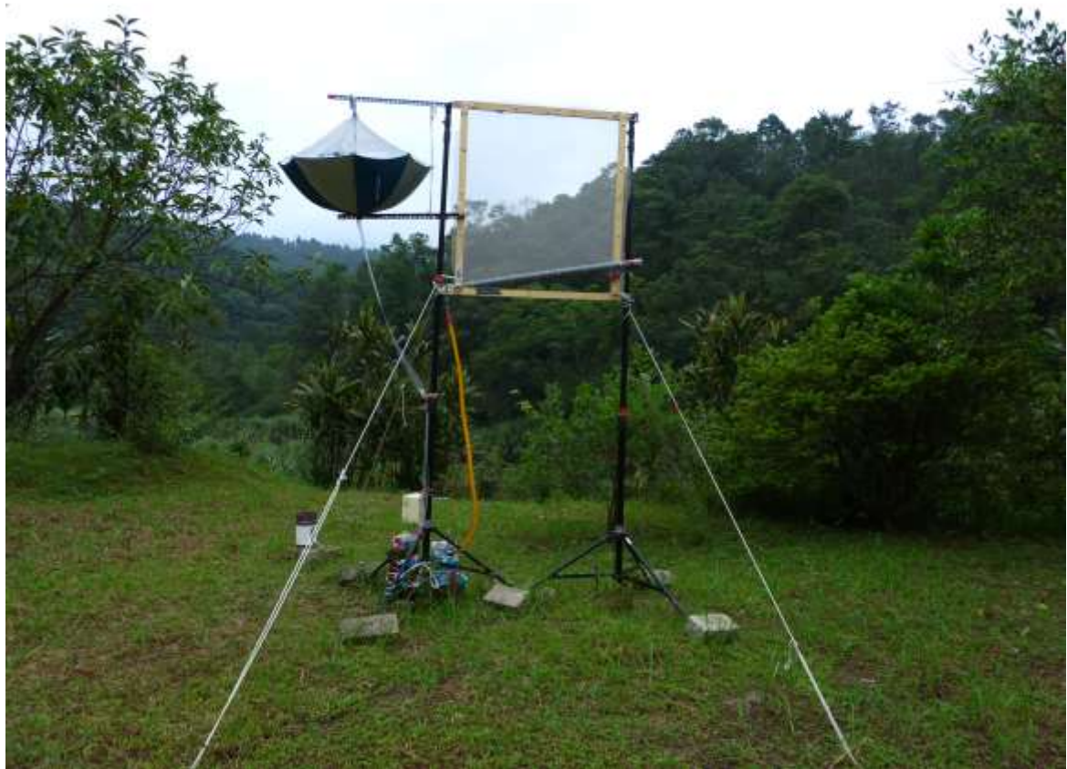
圖 20: 新北市雙溪區山區平面攔截網與工研院傘具的雲霧攔截現場照片，其中攔截網是 1m*1m 見方面積並以木框加以平整網面處理，攔截網材質則與 369 山莊攔截網相同。
