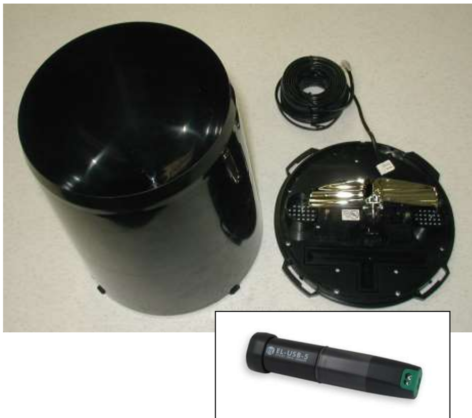
圖 7: 369 山莊斜坡雲霧攔截網氣象站採用的傾斗式雨量筒(Raingauge)與英國 EL-USB5 訊號紀錄器。
