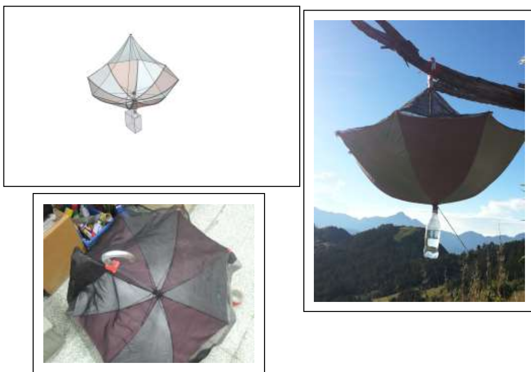
圖 8: 工研院雨傘與台大八角型攔截網搭配示意圖以及 369 山莊斜坡實地測試。
