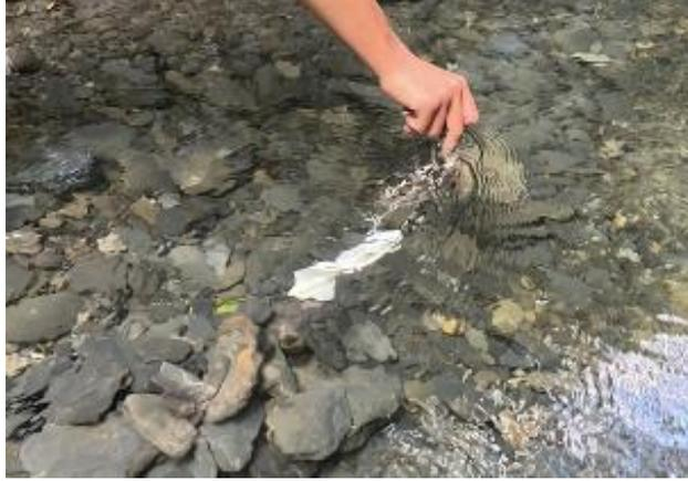
圖六：使用 HYDRO-BIOS 流速計測量流速
