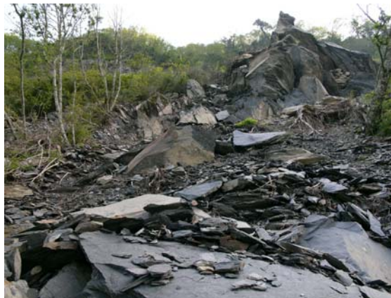
照片 4.10 道路上邊坡板岩變形滑動體及樹木正常生長情況，顯示道路損壞起因於逕流之沖刷和岩屑石板之沖淤。
