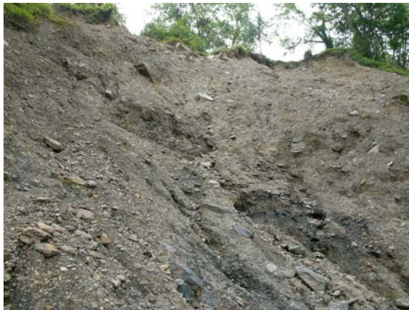
照片 5.28 上坡滑動面出露泥質鬆動變形基岩。
