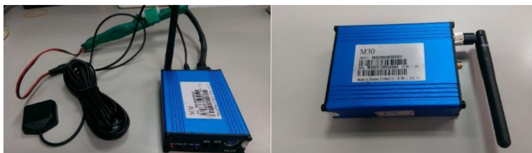
圖 5 GPS 車機整合 3G 通訊技術及設備圖
