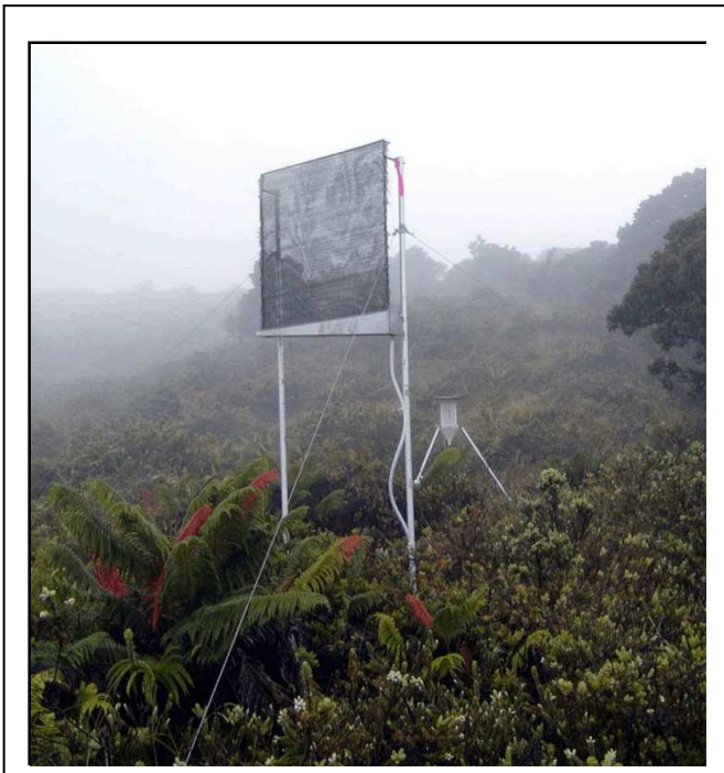
圖 2: 安裝於 Hawaii Maui 島東向坡的平面式(左)與柱狀式(右)霧水蒐集器。引用自 http://water.usgs.gov/nrp/proj.bib/hawaii/maui_fog.htm 。
