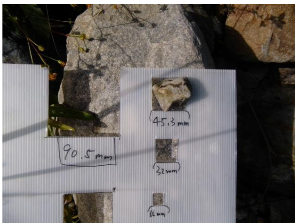
圖 2- 3 開口樣板量測粒徑 (資料來源：本研究團隊)
