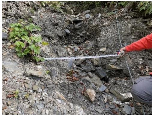
沖蝕溝尺寸量測
