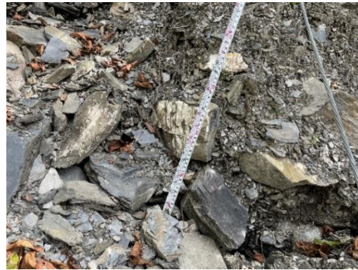
沖蝕溝尺寸量測
