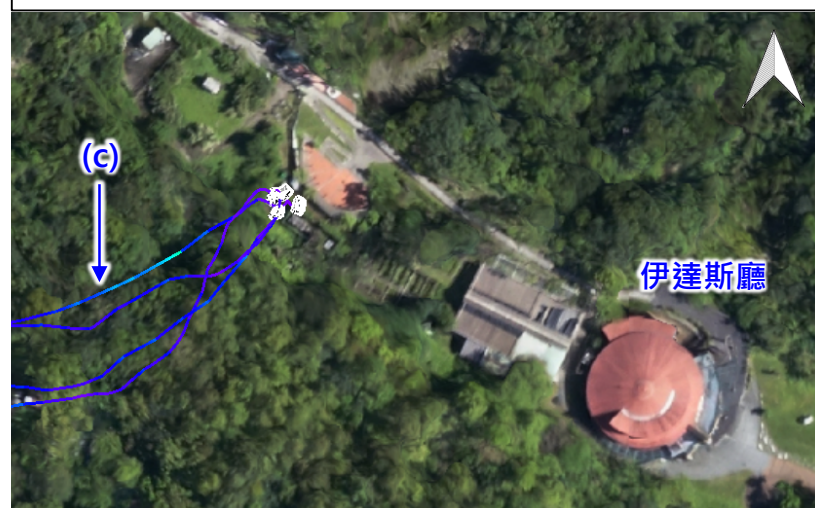
(c) 落石運移軌跡、彈跳高度與落石動能分布
