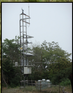
圖1 碧綠神木固定式氣候觀測站的記錄參數目前包括氣溫、溼度、風速、風向、風、雨量及雲霧等等。
