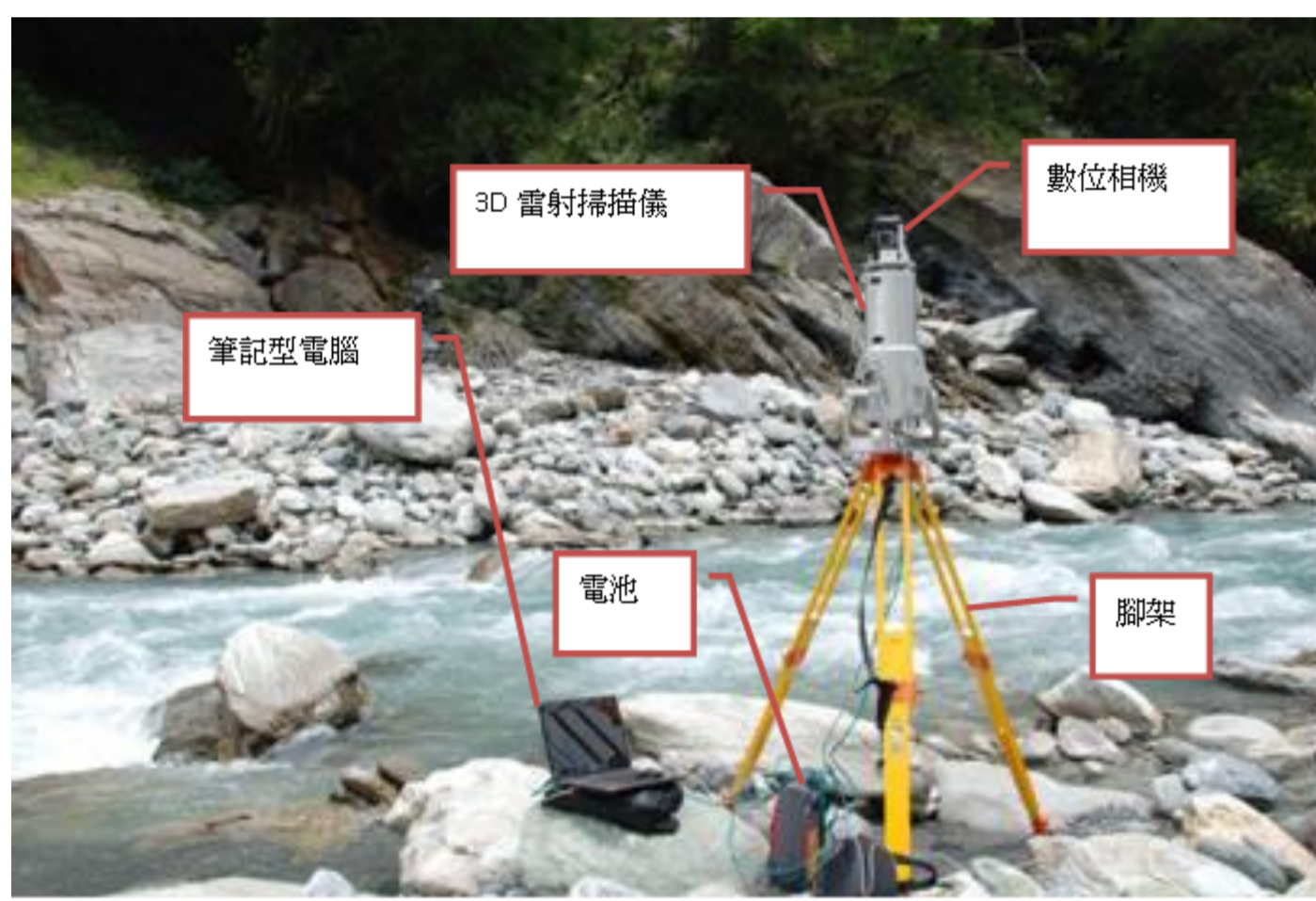
三維雷射掃描儀架設情形
