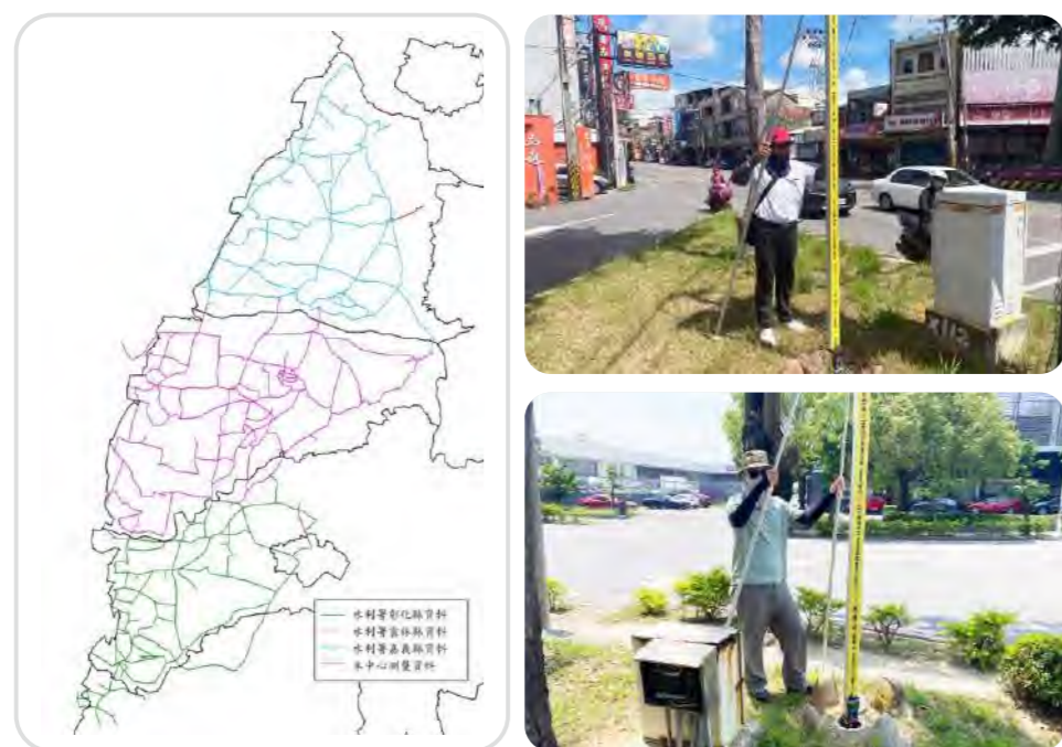
▲ 圖4-1 地層下陷區水準測線圖及作業情形
