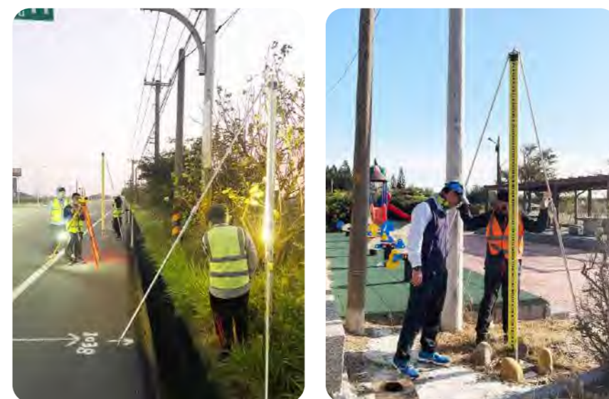
▲ 圖4-2 西南沿海下陷區一等水準點正高檢測情形
