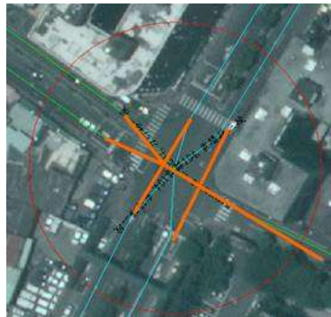
圖 15、交叉路口前後之道路中線數量對等_井字接法 圖 16、交叉路口前後之道路中線數量不對等_米字接法
