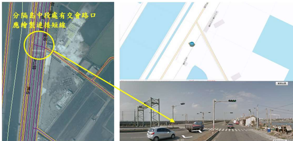
圖 17、分隔島不連續處兩側有路口交會，分隔設施中斷處須繪製雙道路線間之連接短線
