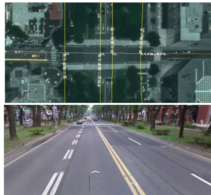
圖 12、具實體分隔(或快慢車道分隔者)之道路中線繪製_道路中線須分別繪製
