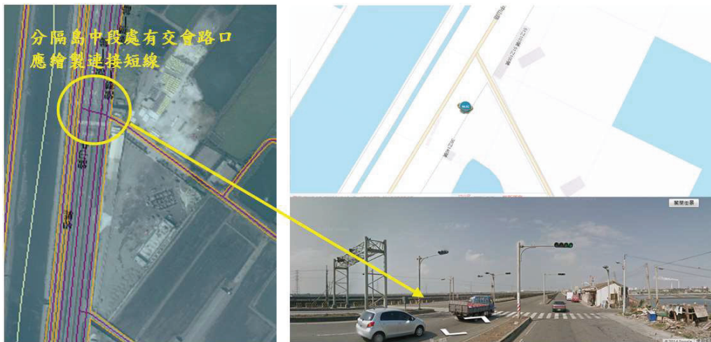
圖 16、分隔島不連續處兩側有路口交會，分隔設施中斷處須繪製雙道路線間之連接短線
