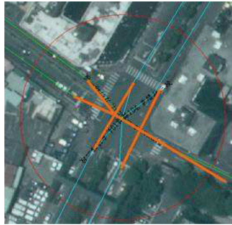
圖 14、交叉路口前後之道路中線數量對等_井字接法 圖 15、交叉路口前後之道路中線數量不對等_米字接法
