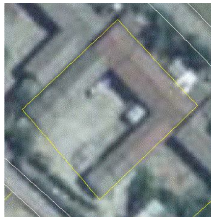
圖 30、三合院示意圖(包含前面空地測繪為單棟建物)
