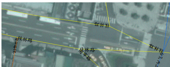
圖 11、具道路中央分隔設施(如：反光防撞桿)之道路中線繪製圖_道路中線儘量分隔繪製
