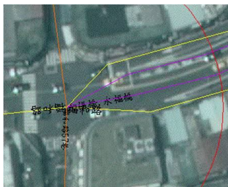
圖 8、高架/橋梁與平面道路之匯集方式
