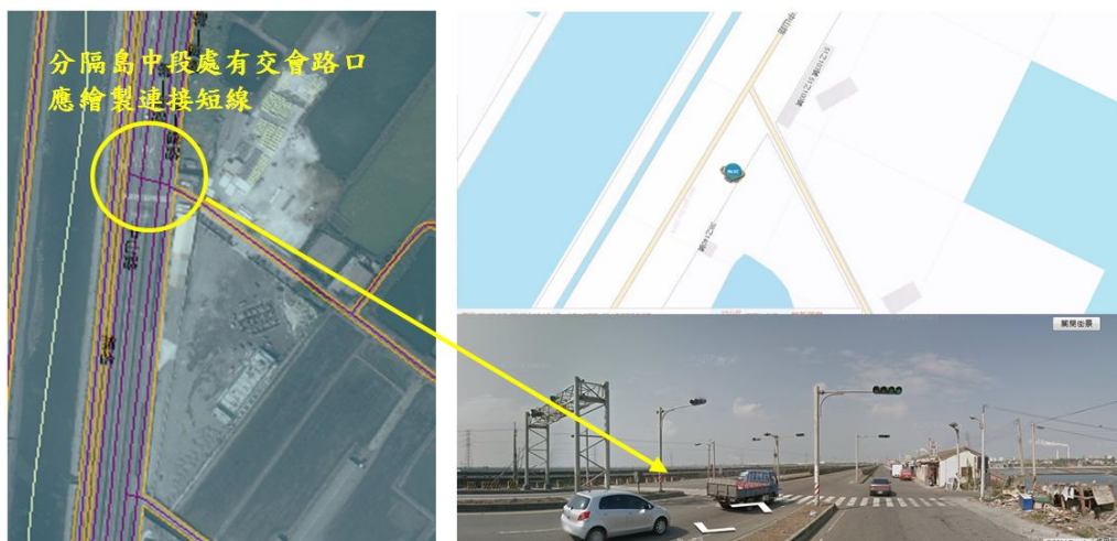
圖 15、分隔島不連續處兩側有路口交會，分隔設施中斷處須繪製雙道路線間之連接短線
