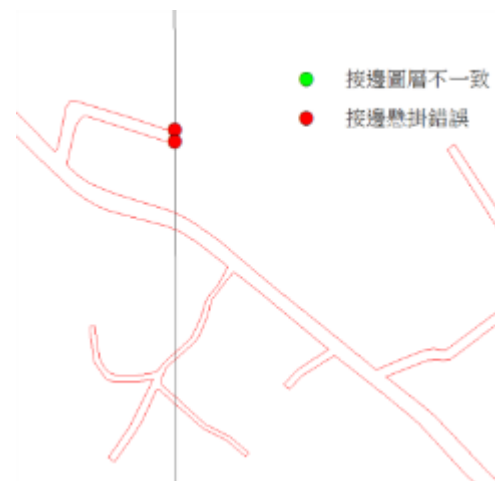
圖 4.5-2 接邊錯誤態樣(圖元遺漏)
