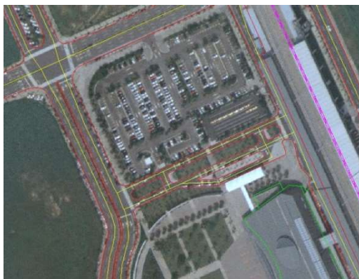
圖 9、具實體分隔之道路中線繪製圖_道路中線須分別繪製
