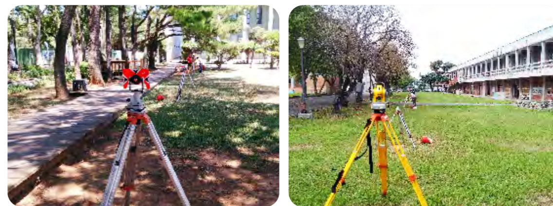
▲ 圖 4-65 簡易電子測距基線場檢測標準距離作業情形
