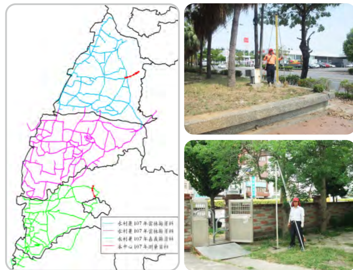
▲ 圖4-3 地層下陷區水準測線圖及作業情形
