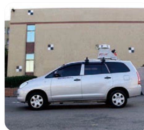
▲車載式光達移動測繪系統率定試辦作業情形(港灣技術研究中心)
