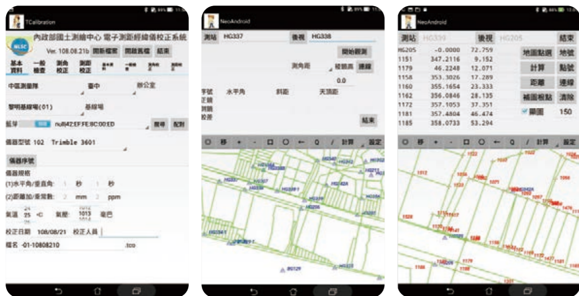
▲ 圖4-22 測量外業自動化暨電子測距經緯儀校正系統畫面
