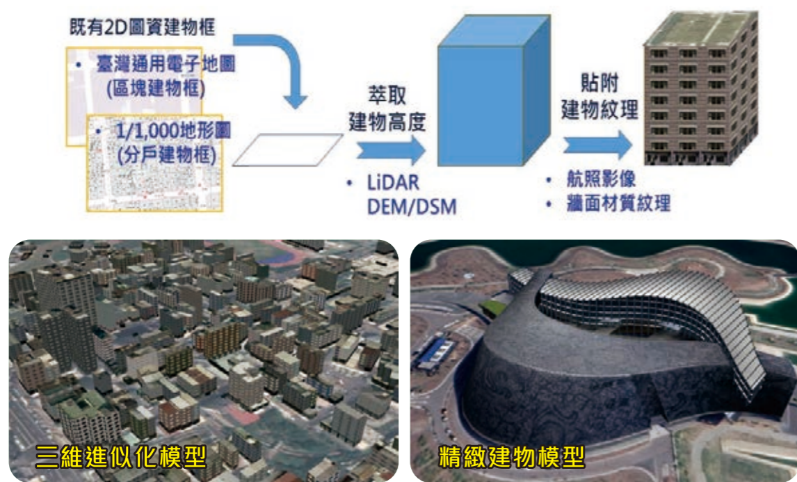
▲ 圖4-54 三維近似化建物模型產製流程及成果
