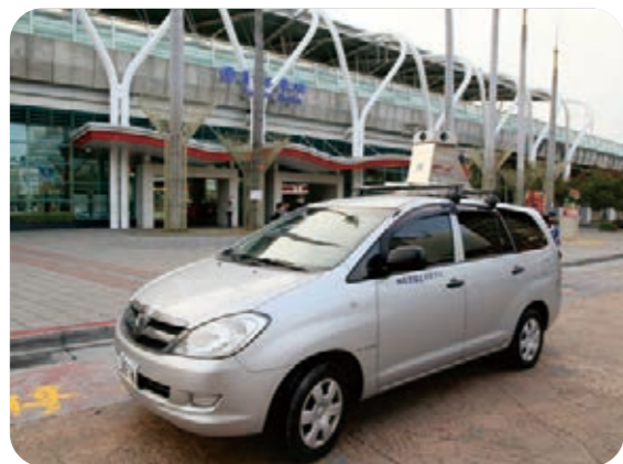
▲車載式光達移動測繪系統局部圖資更新作業掃描情形(彰化縣員林火車站)
