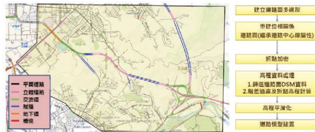
▲ 圖4-56 產製LOD1三維道路模型試辦區範圍圖及流程
