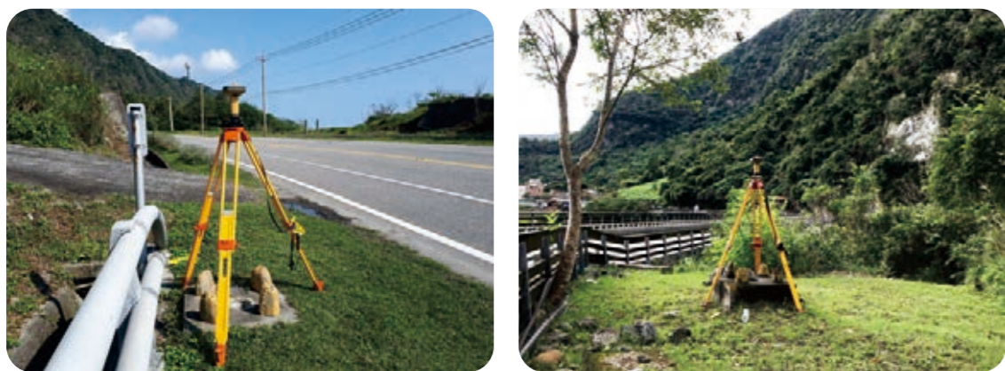
▲ 圖4-7 一等水準點幾何高檢測作業情形
