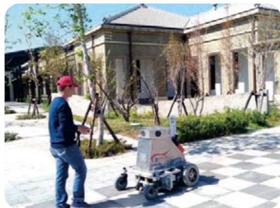
▲遙控式光達移動測繪系統掃描作業情形(帝國製糖廠臺中營業所)
