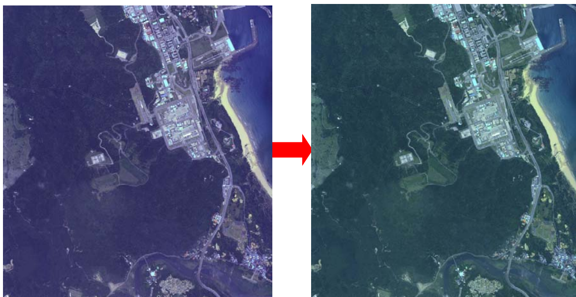
圖 2-11 105 年度正射影像無接縫影像拼接示意圖
