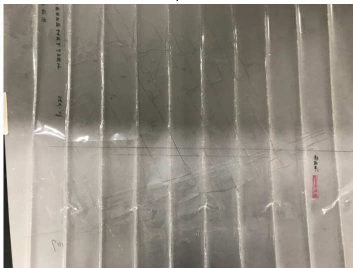
圖 3-40 謄繪圖膠片破損情形
