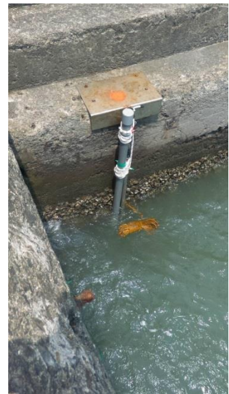
圖 3-9 本案潮位站架設情形(由左至右依序為彌陀、鳳鼻頭以及枋寮潮位站)
