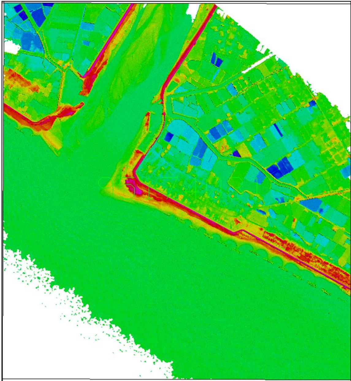
圖 3- 68 95174031 單幅點雲成果圖(高程上彩)圖
