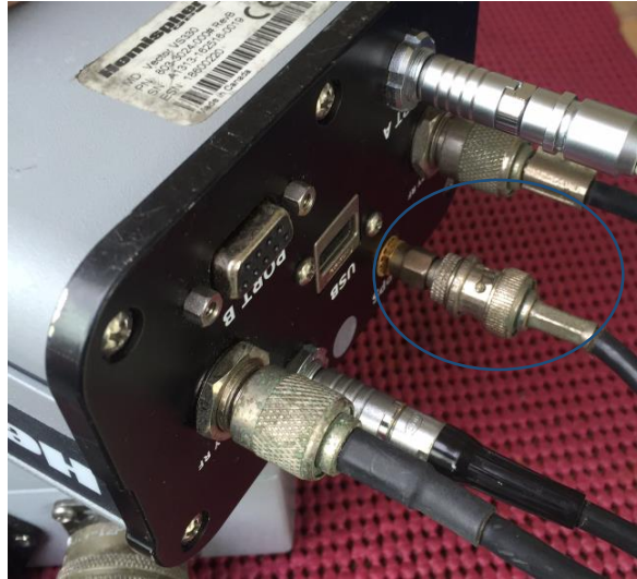
圖 3-12 以 GNSS 儀器之 PPS 訊號作為校時器
