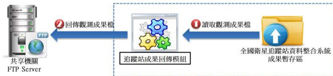
附圖 5-3 國土測繪中心自動回傳觀測成果程序圖
