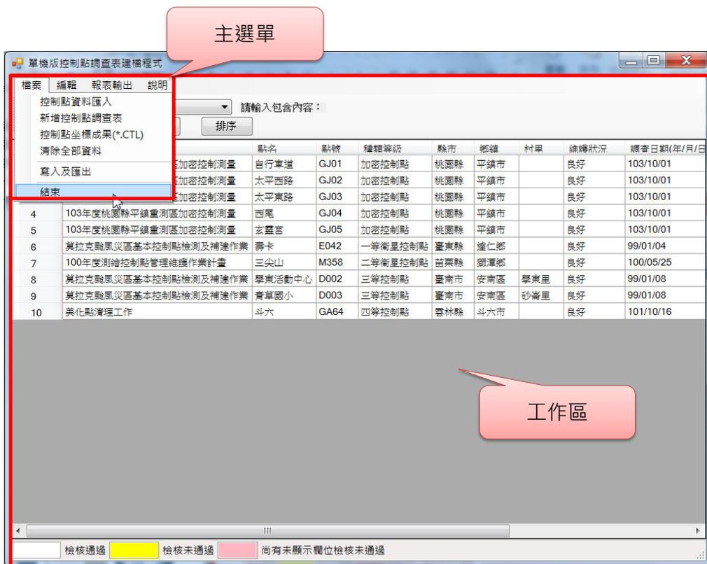
圖 16 控制點調查表建檔程式版面配置
