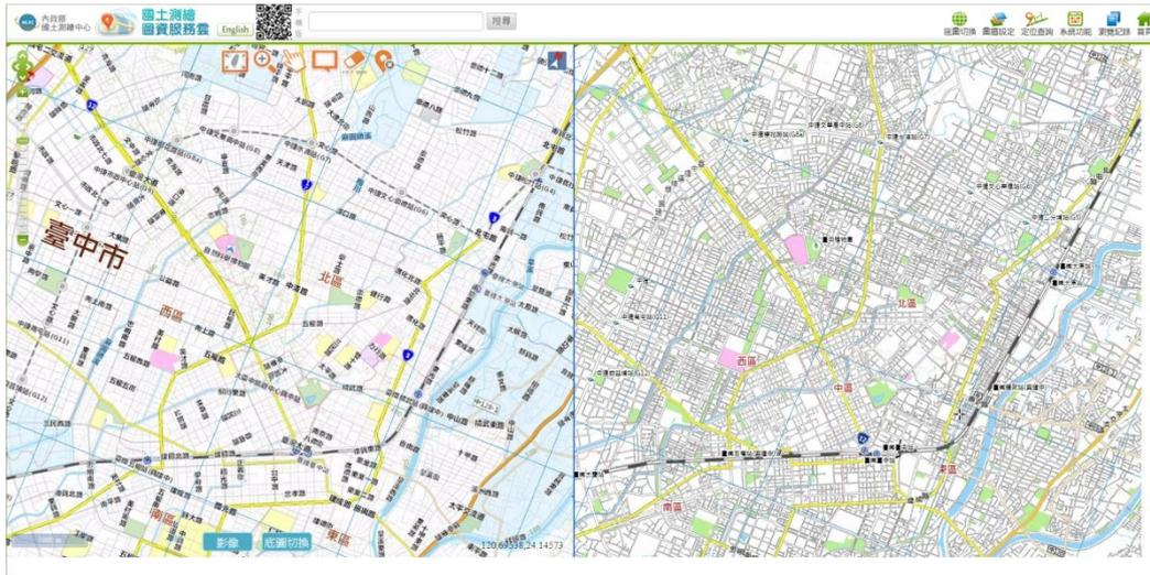
圖 4-11 文字向量圖磚(右)與網格圖磚(左)之比較(13 階層，旋轉約 45 度)
