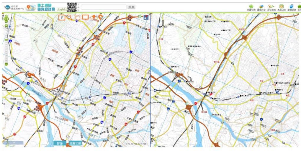
圖 4-12 文字向量圖磚(右)與網格圖磚(左)之比較(12 階層，旋轉約 45 度)
