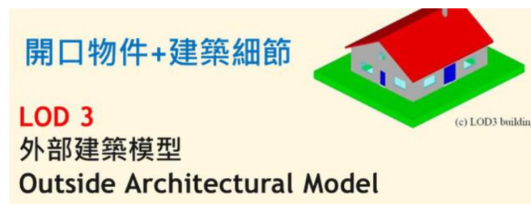
圖 3-31 CityGML 定義 LOD3 建物模型(OGC)
