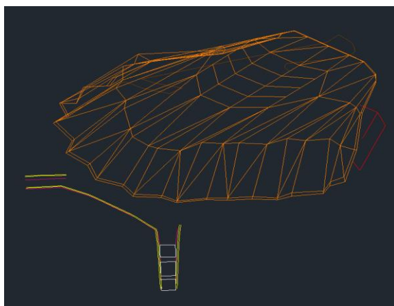
a. 航照影像量測屋頂結構
