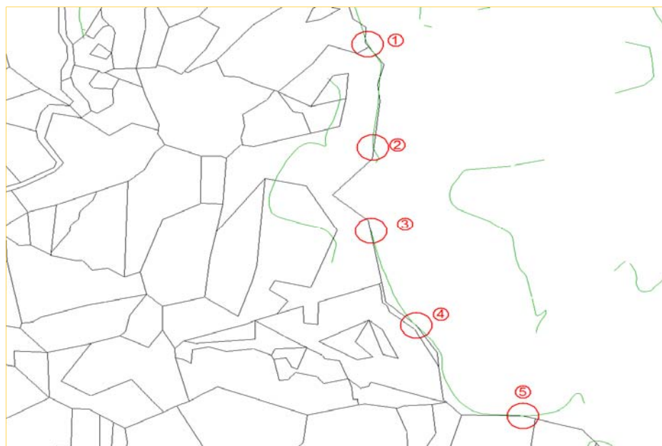
圖5-6 地形圖地類與地籍圖經界線相似或接近區域示意圖
