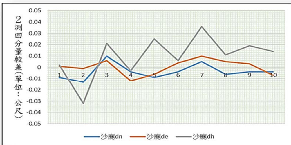
圖4-9 沙鹿實驗區圖根測量2測回分量較差示意圖
