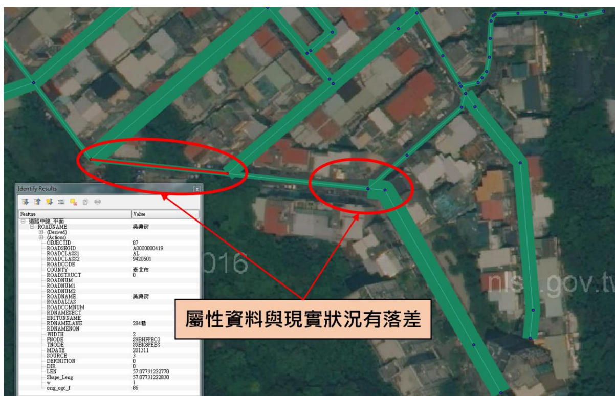
圖 3-2 利用道路中線及既有欄位建立多邊形示意圖
