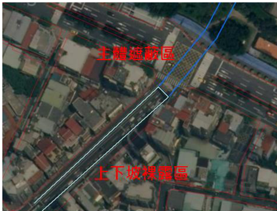
圖 5-30 地下道兩種不同結構形式
