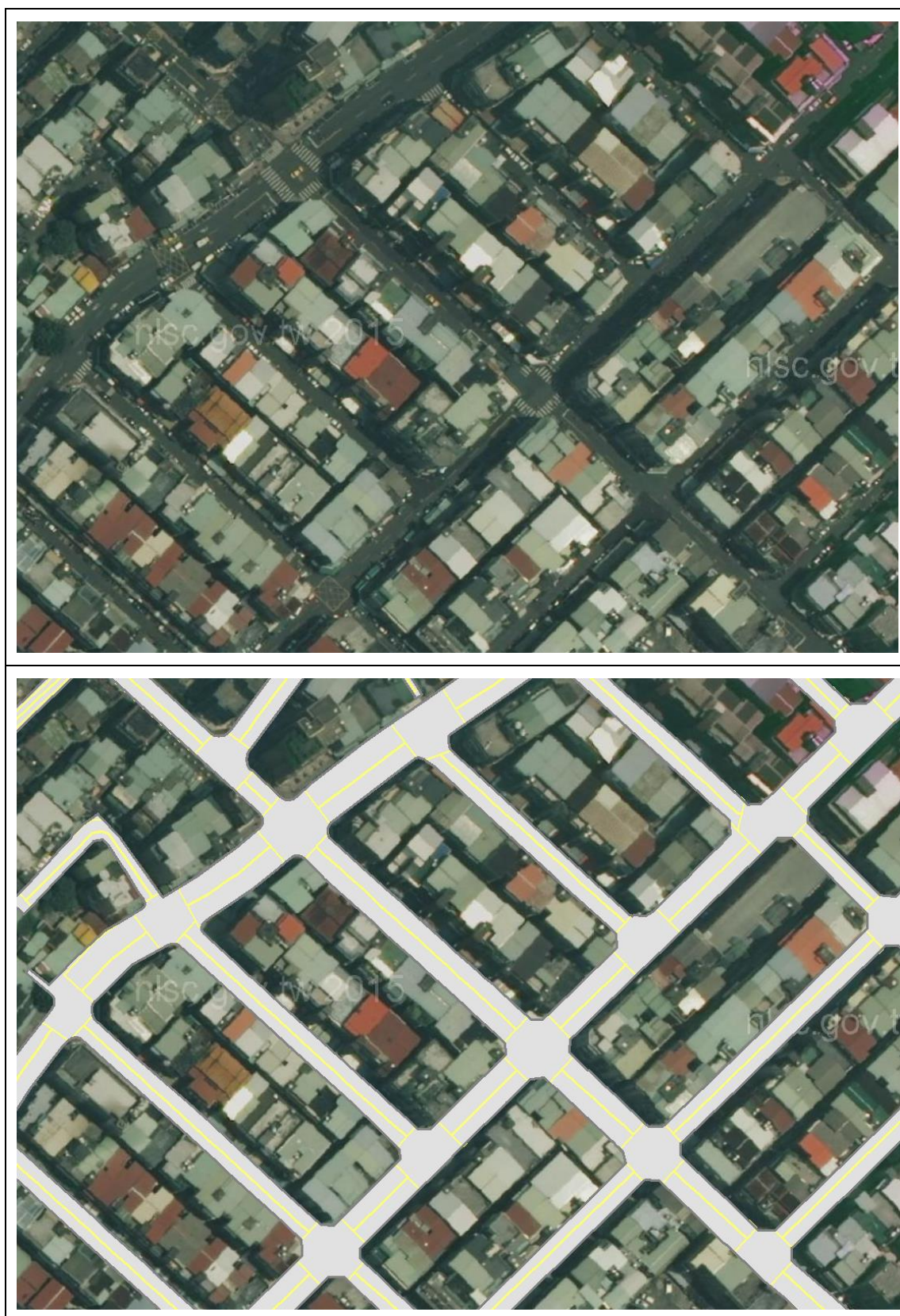
圖 3-23 模擬道路標線產製道路紋理材質示意圖
