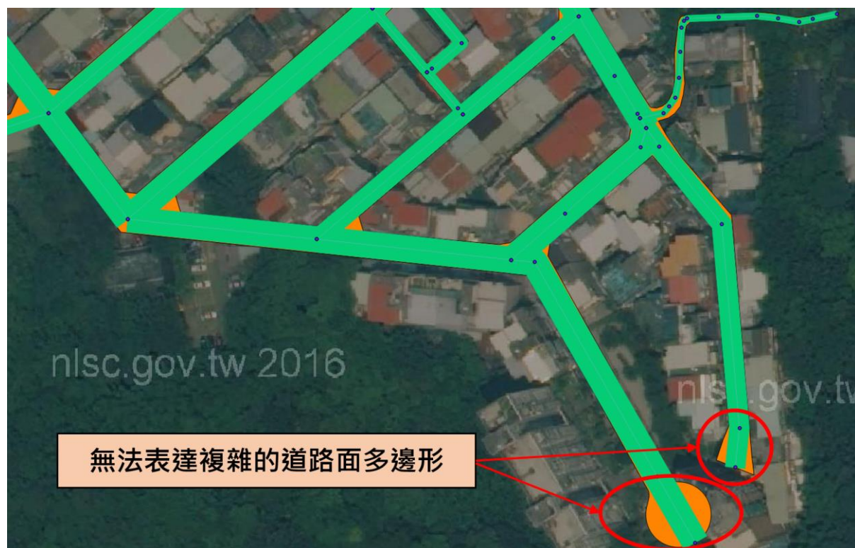
圖 3-3 利用道路中線及計算成果建立多邊形示意圖
