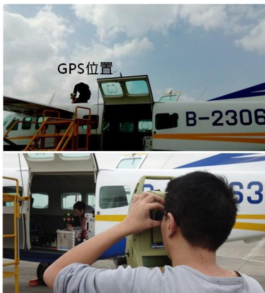
圖4-3、Lever Arm量測作業
