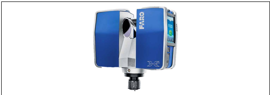
圖 8-3 FARO FOCUS X 330 儀器外觀
