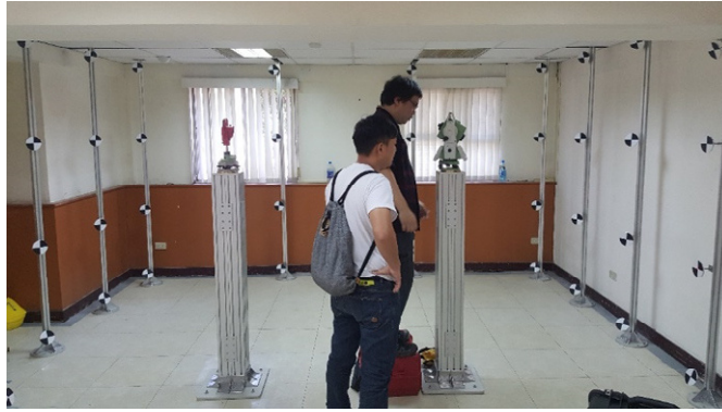
圖 8-6 Leica 的全站儀室內參考值量測現況
