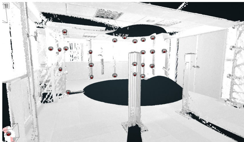
圖 7-11 初始校正標偵測成果
