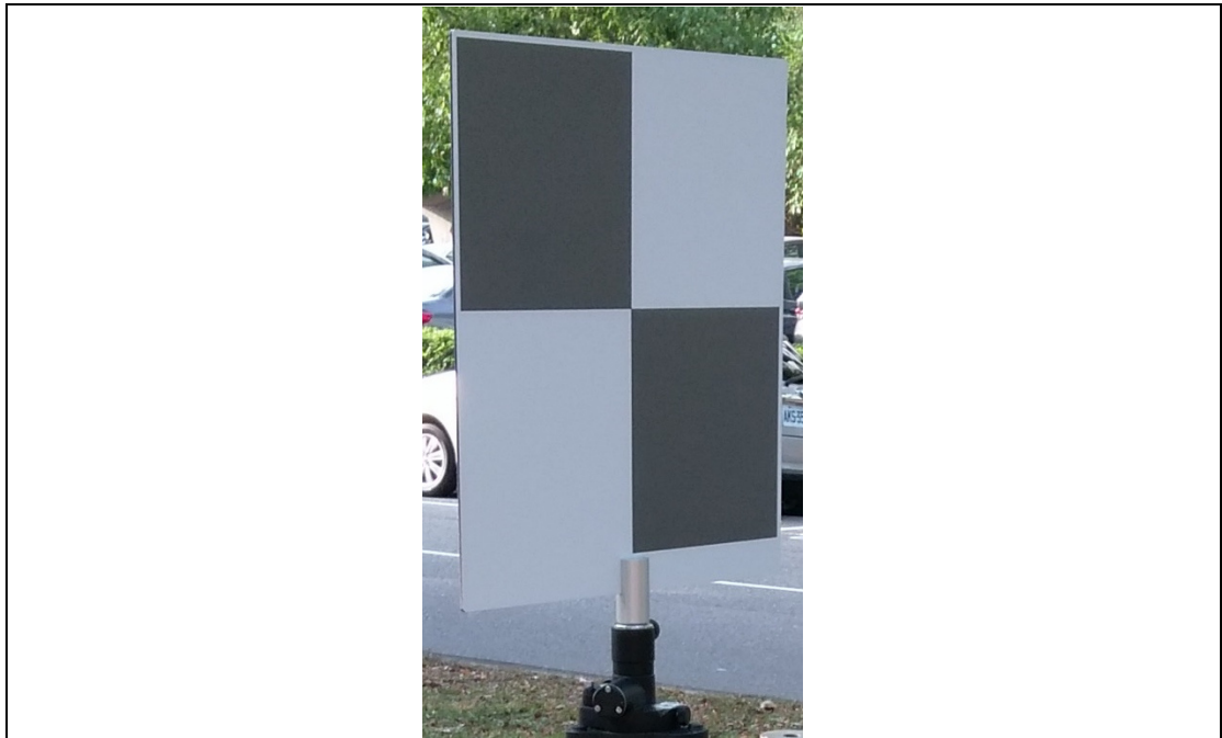
圖 6-7 測距基線校正場，雷射掃描校正標完成圖
