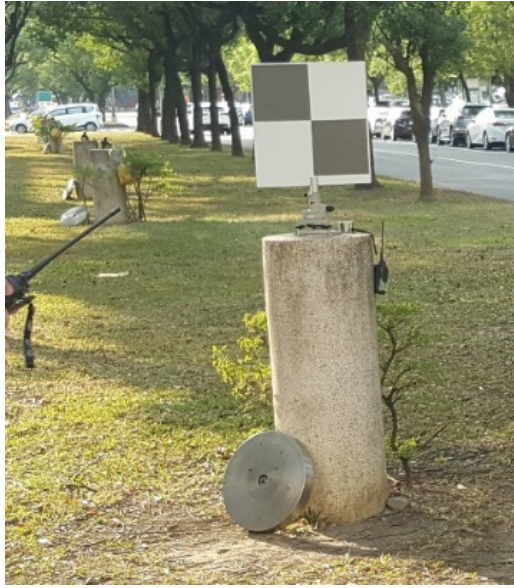
圖 6-10 測距基線校正場校正標布設圖
