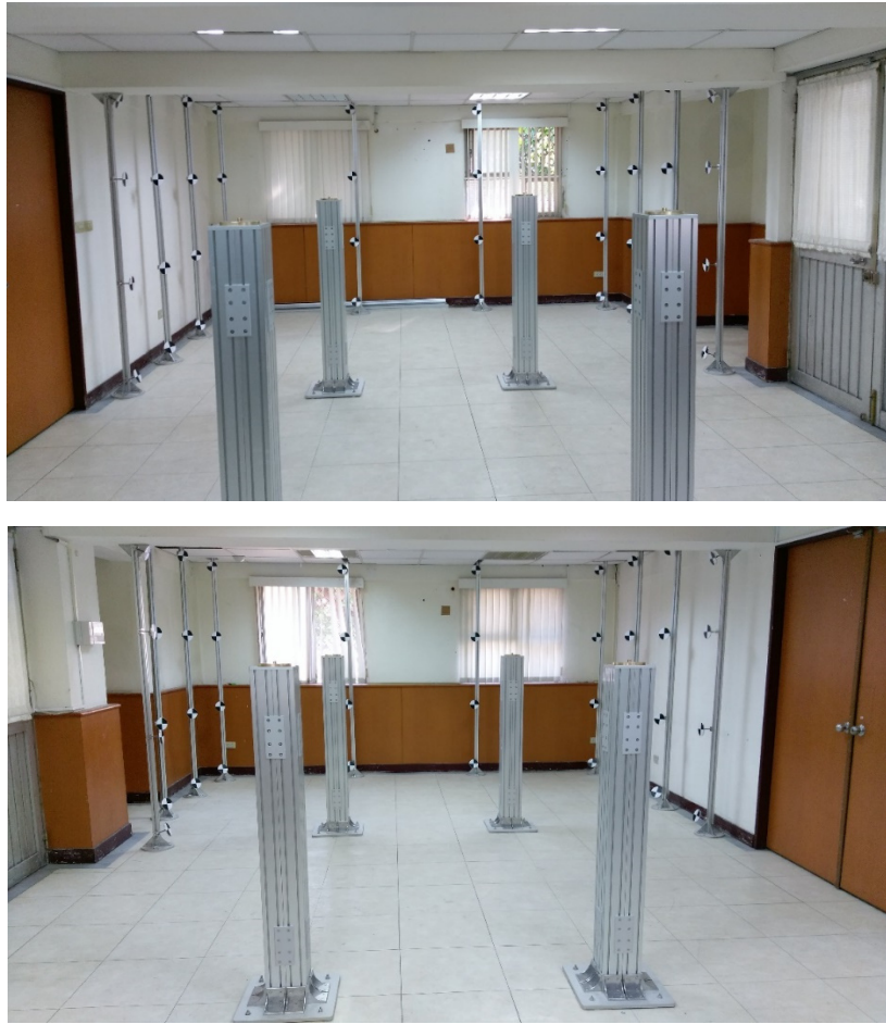
圖 6-9 室內場校正標與儀器基樁布設圖(上圖朝南拍照，下圖朝北拍照)
