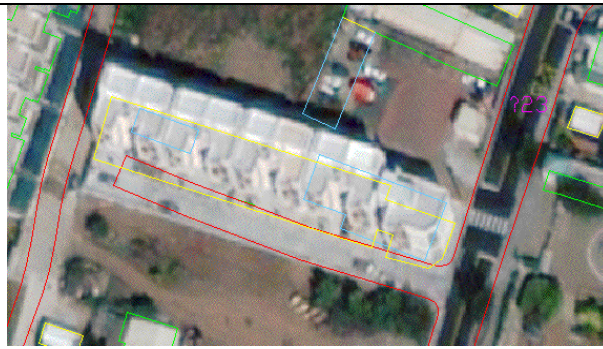
(b)修正完高差位移後成果
