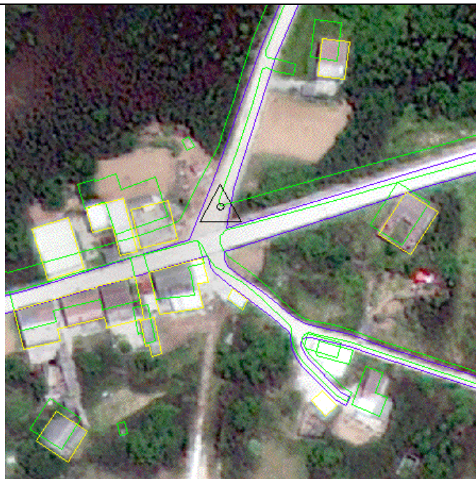
(c)錯誤案例：本處應該無須修測 (綠色為原電子地圖成果，紫色為修測後成果)
