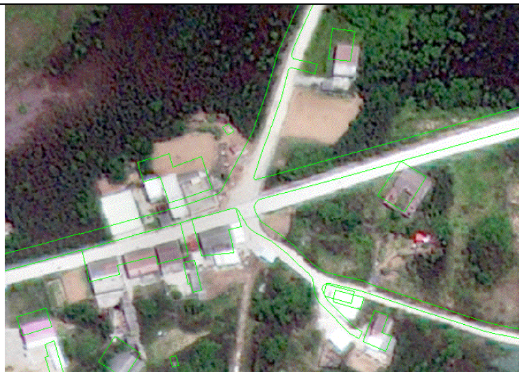
(a)原始衛照無法與舊電子地圖成果套合一致
